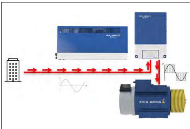
ZAreC4C – Leistungsrückgewinnungseinheit / Motorbetrieb Bild: BUTZ AUFZÜGE GmbH
